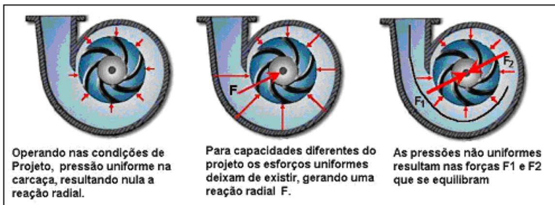
**Figura 20 - Reações radiais em carcaça do tipo voluta**
