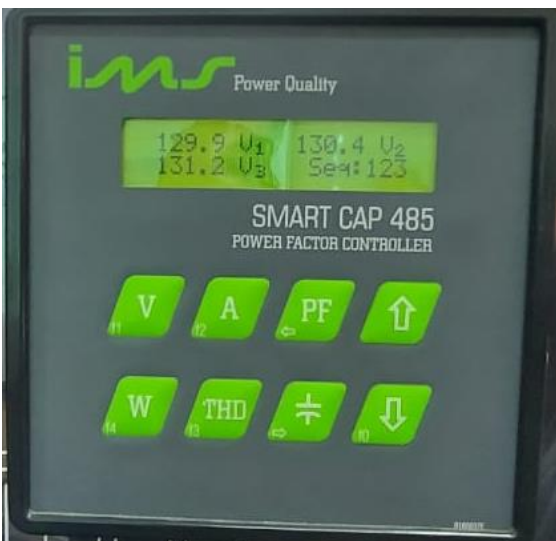
Figura 8 – Valores das tensões nas três fases Fonte: Arquivo pessoal dos autores
