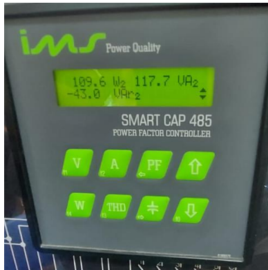
Figura 12 – Potência Ativa, Reativa e Aparente na Fase 2 Fonte: Arquivo pessoal dos autores
