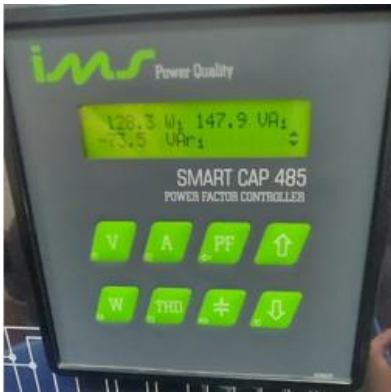
Figura 11 – Potência Ativa, Reativa e Aparente na Fase 1 Fonte: Arquivo pessoal dos autores
