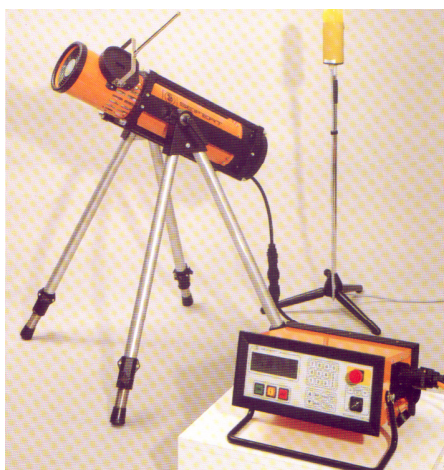
Equipamentos de radiação ionizante industrial, de até 300 kV
