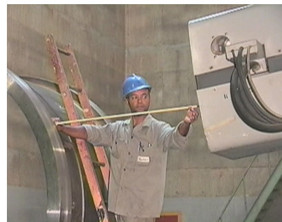
Fotos de um acelerador linear usado para radiografia industrial de peças com espessura de 20 a 300 mm de aço.
