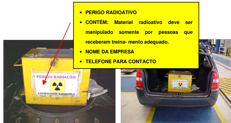
Caixa metálica que contém o irradiador Fixação da caixa metálica no veículo
