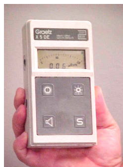
Detector Geiger Muller digital, atua numa faixa de energia de 40 keV até 3 MeV com precisão de \pm 20\% , possui escalas automáticas de 1 \mu\text{Sv/h} até 9,99 \text{ mSv/h} , com peso de 500 gramas
