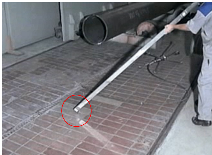
Simulação de resgate de um porta-fonte contendo uma fonte radioativa industrial, com uso da garra especial para resgate.
