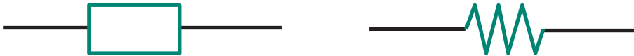
Figura 4.3: Símbolos gráficos de representação da resistência em um circuito elétrico Fonte: Adaptado de Halliday et al. (2000)
