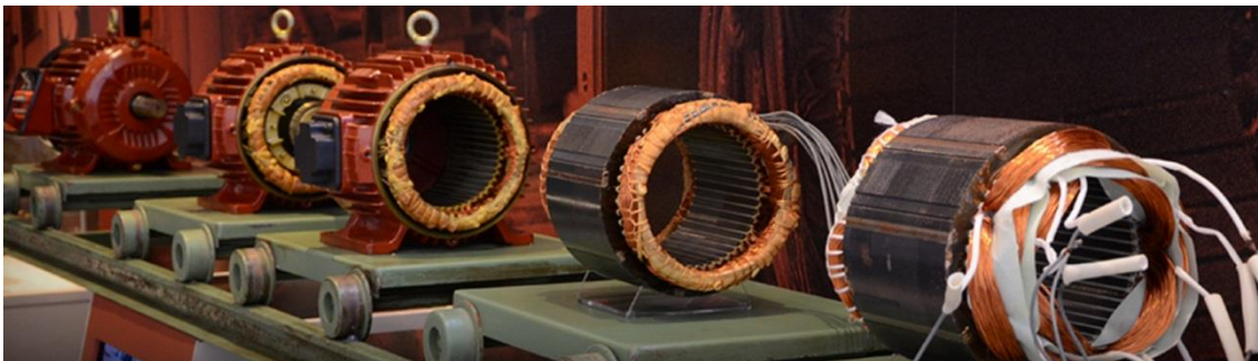
Figura 4: Processo de montagem do Motor de Indução Trifásico
