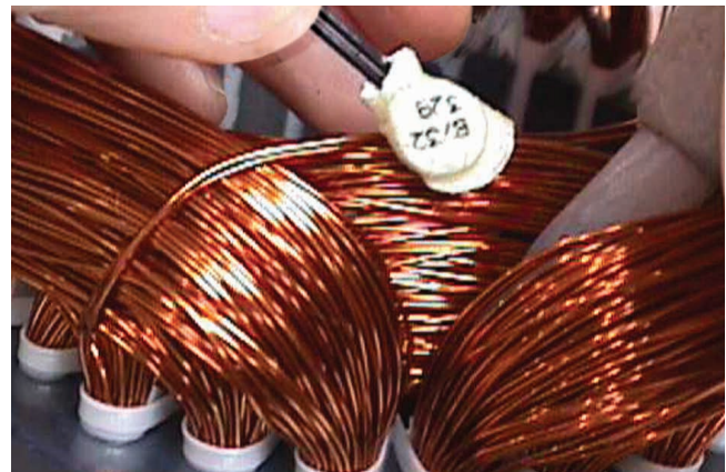
Figura 7.6 - Instalação do protetor térmico bimetálico
