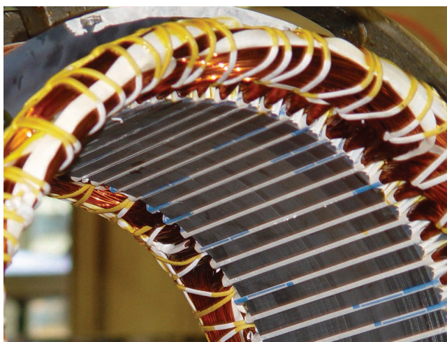
Figura 1.12a – Fios e Filmes aplicados no estator
