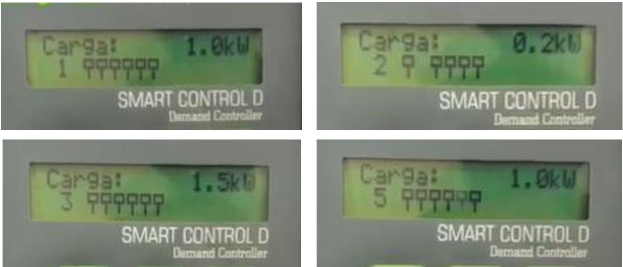
Figura 5 – Programação dos valores de carga no Smart Control D
