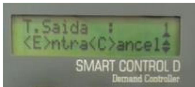
Figura 12 – Configuração do tempo de desligamento no Smart Control D
