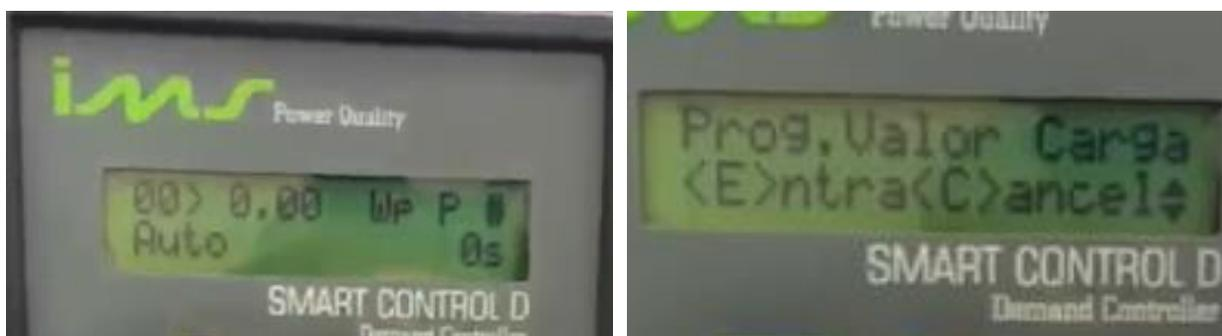
Figura 4 – Acessando o modo de configuração do Smart Control D
