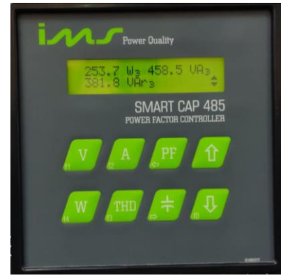
Figura 13 - Potência Ativa, Reativa e Aparente na Fase 3 Fonte: Arquivo pessoal dos autores
