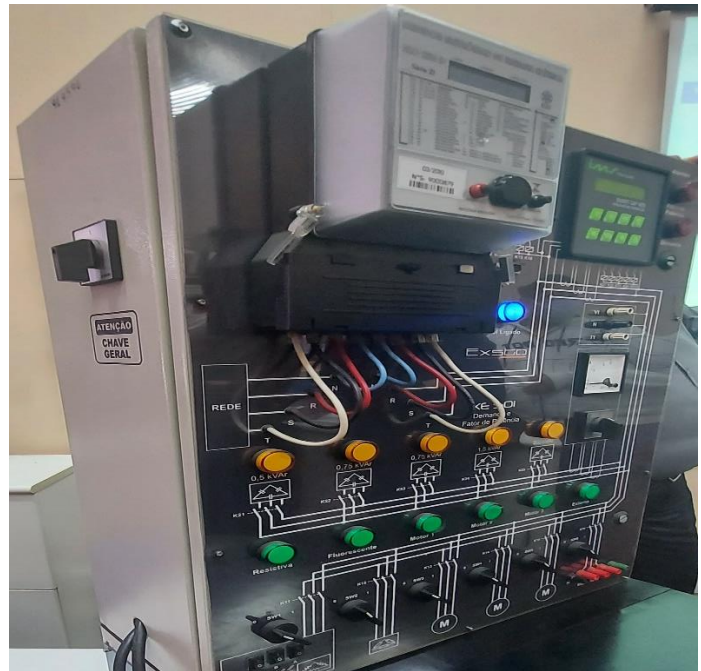
Figura 2 - Kit para análise de energia (vista do painel de controle) Fonte: Arquivo pessoal dos autores
