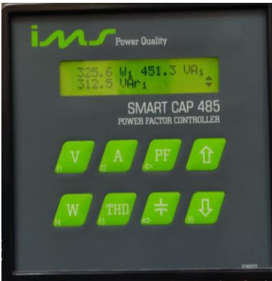
Figura 11 - Potência Ativa, Reativa e Aparente na Fase 1 Fonte: Arquivo pessoal dos autores
