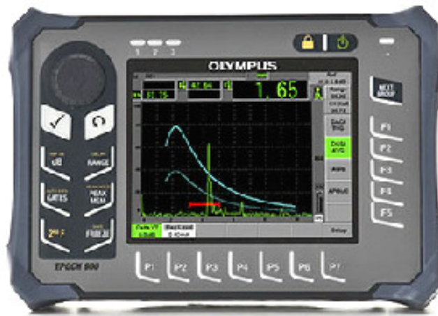
Aparelho de ultrassom digital marca Olympus modelo EPOCH 600.
