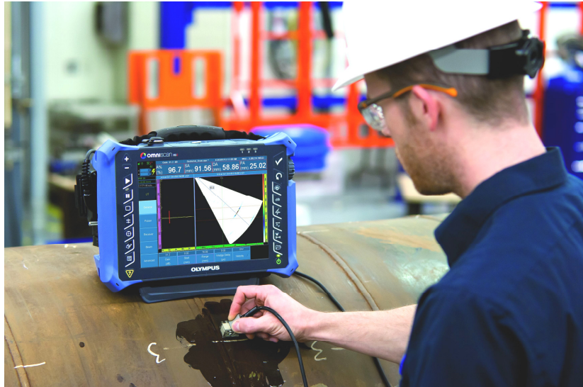
Inspeção típica de uma solda usando a técnica Phased-Array. Aparelho de ultrassom OmniScan MX2 – Cortesia da Olympus
