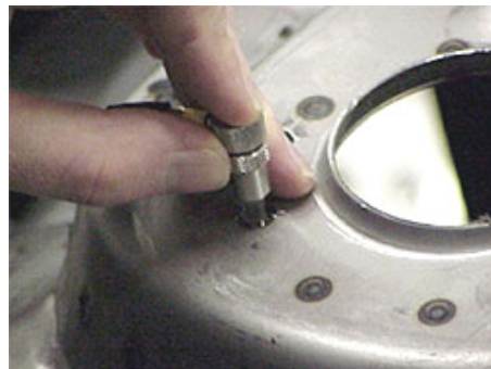
Equipamento portátil para inspeção de soldas a ponto por ultrassom
