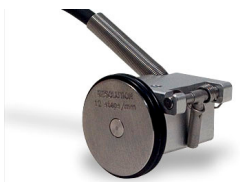
Encoder Olympus modelo Mini-Wheel usado para posicionamento e dimensionamento de indicações no eixo de varredura. Isto sincroniza a aquisição dos dados com o movimento do transdutor.
