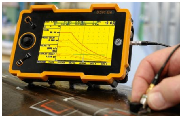
Aparelho de ultrassom marca GE modelo USM GO
