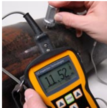
Medidor de Espessura Digital Ultrassônico GE Modelo DM4E http://www.geinspectiontechnologies.com
