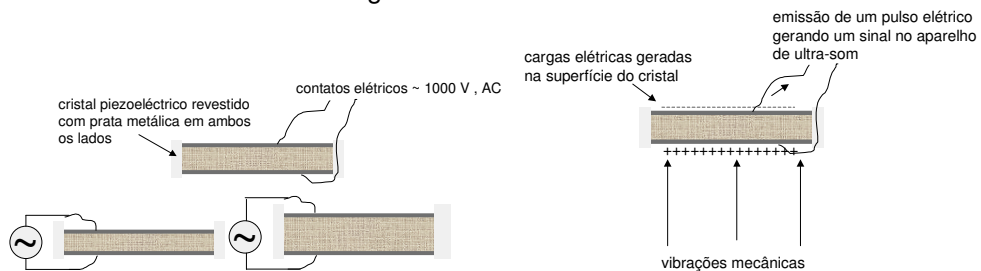
Figura mostrando a contração e expansão do cristal quando submetido a uma alta tensão alternada na mesma frequência ultrassônica emitida pelo cristal. É um processo de transformação da energia elétrica em energia mecânica e vice-versa
