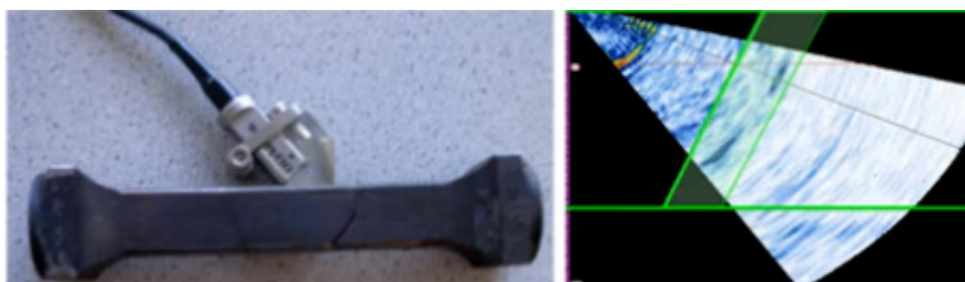
Foto mostrando a detecção de uma trinca e a imagem Phased Array correspondente (Cortesia da Olympus)
