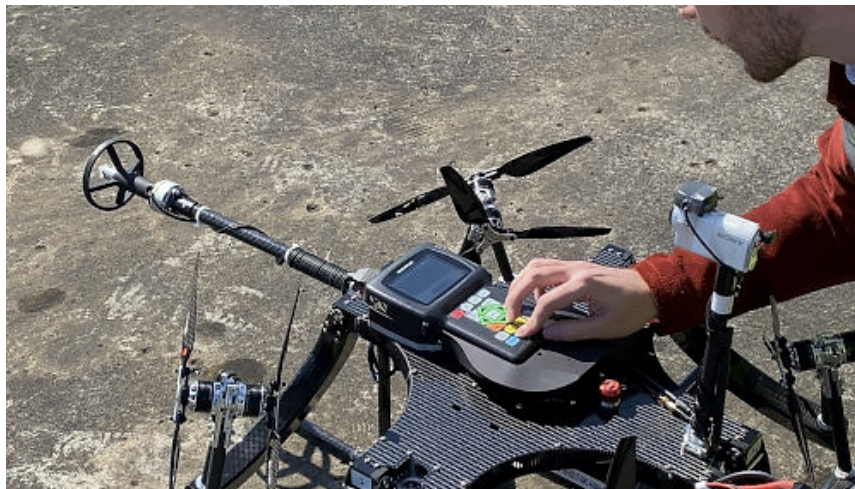
Preparação do sistema de medidor de espessura para ser elevado pelo drone Fonte: Skygauge Robotics
