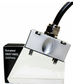
Transdutor com sapata intercambiável angular 60 graus 64 elementos, Sonatest
