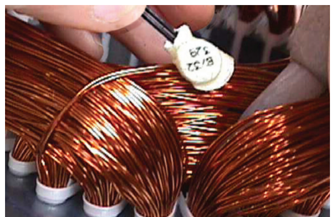
Figura 7.6 - Instalação do protetor térmico bimetálico
