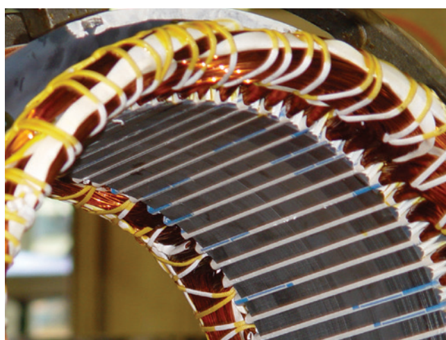
Figura 1.13a – Fios e Filmes aplicados no estator
