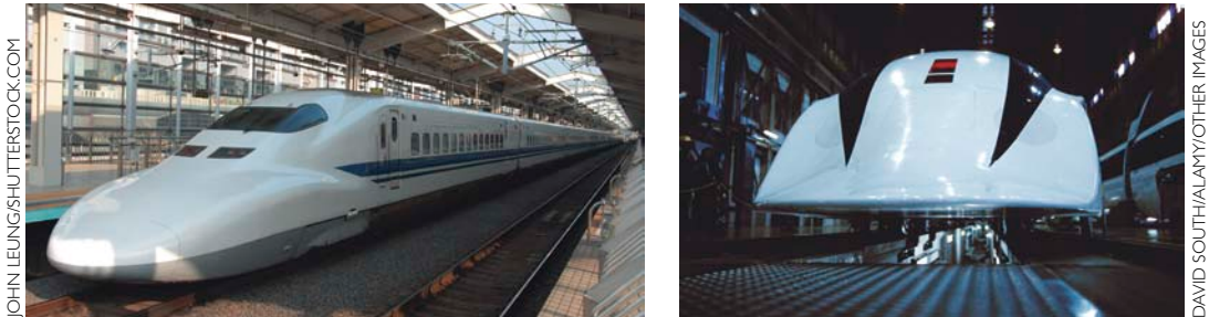
Figura 2.17 Trem-bala japonês (Shinkansen) levitado (Japan Railway), que utiliza magnetos supercondutores.
