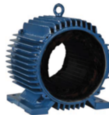
5. Queima por sobrecarga.
