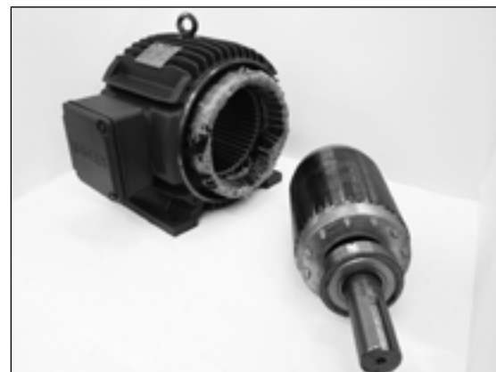
H-Retirar o conjunto do rotor do interior do motor com o máximo cuidado, evitando qualquer dano à bobinagem.
