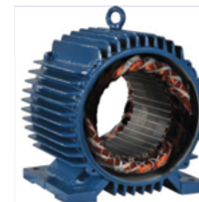
8. Falta de fase (ligação triângulo).
