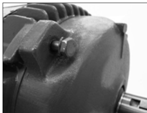
F - Retirar os parafusos que fixam as tampas. Verificar a existência de flange interna retirando seus parafusos
