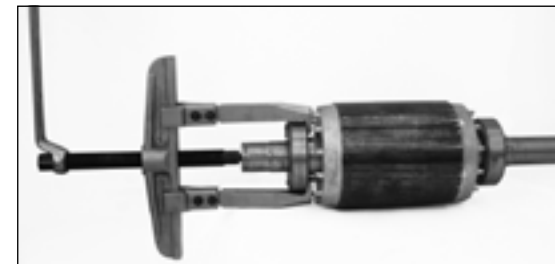
I - Retirar do eixo os rolamentos danificados, por meio de extrator ou prensa.
