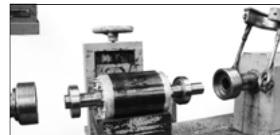
J - Montar os rolamentos novos com o auxílio de uma prensa, apoiando somente sobre a pista interna.
