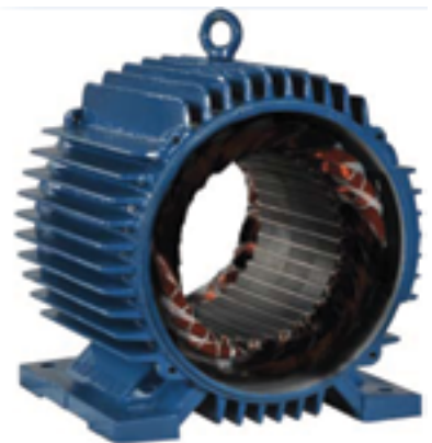
9. Falta de fase (ligação estrela).
