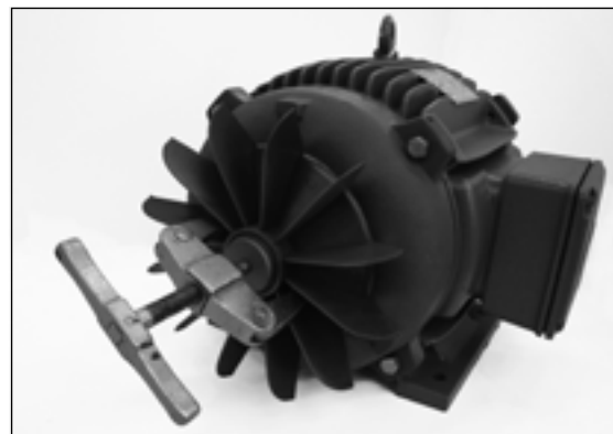
C - Retirar o ventilador utilizando-se de um extrator adequado.
