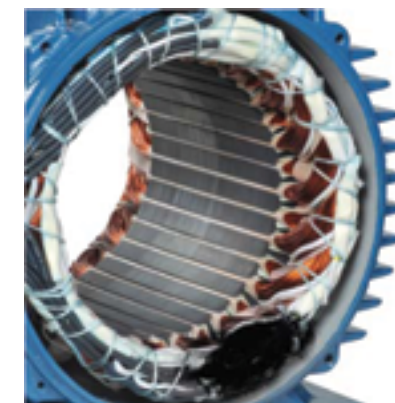
2. Curto na conexão.
