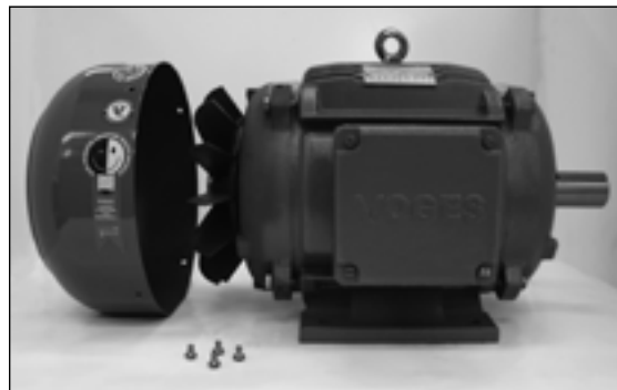
A - Retirar a calota que protege o ventilador. Para esta operação, basta retirar os quatro parafusos que fixam a calota à tampa.
