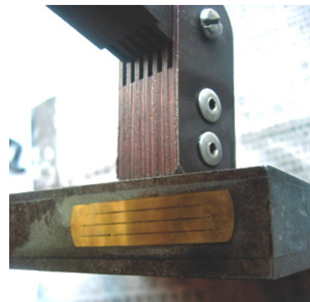
Técnica de inspeção de fundidos usando Yoke com pernas articuláveis à esquerda e uso do padrão Castrol na borda de uma peça à direita.
