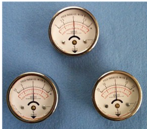
Instrumentos de medição/ indicação de campo magnético residual denominado Gaussímetro. Quando colocado sobre a superfície do material inspecionado, o instrumento deve indicar , com pouca precisão , o campo magnético residual ( foto extraída do catálogo da Magnaflux )
