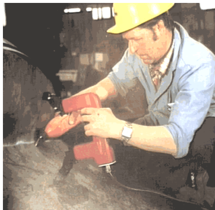
Técnica de inspeção de fundidos usando Yoke com pernas articuláveis à esquerda e uso do padrão Castrol na borda de uma peça à direita.
