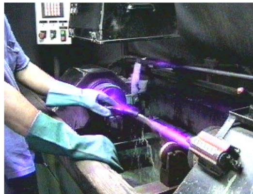
Inspeção de eixos automotivos pela técnica contato direto
