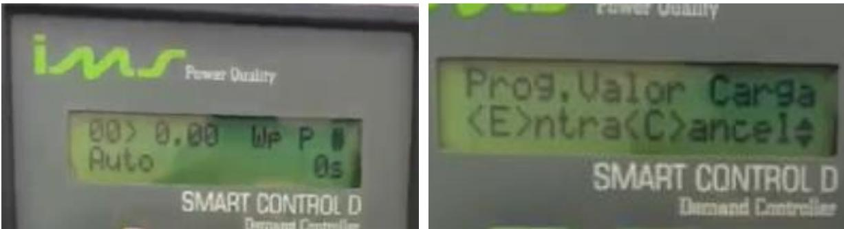
Figura 5 – Acessando o modo de configuração do Smart Control D
