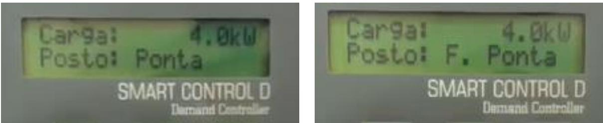
Figura 6 – Configuração de demanda no Smart Control D
