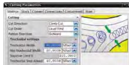
*O padrão de corte trocoidal no NX impede automaticamente que você exceda as condições de corte permitidas com base em critérios específicos do usuário.*
