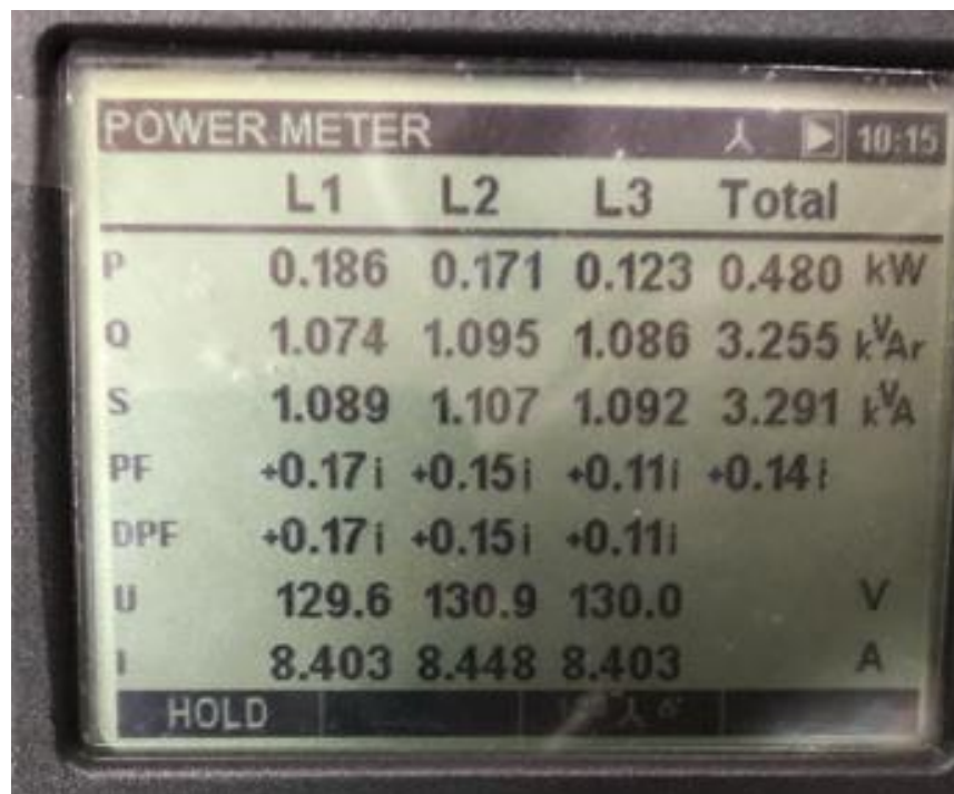
Figura 30 - Valores de potência ativa total, reativa total e aparente total sem correção Fonte: Arquivo pessoal dos autores
