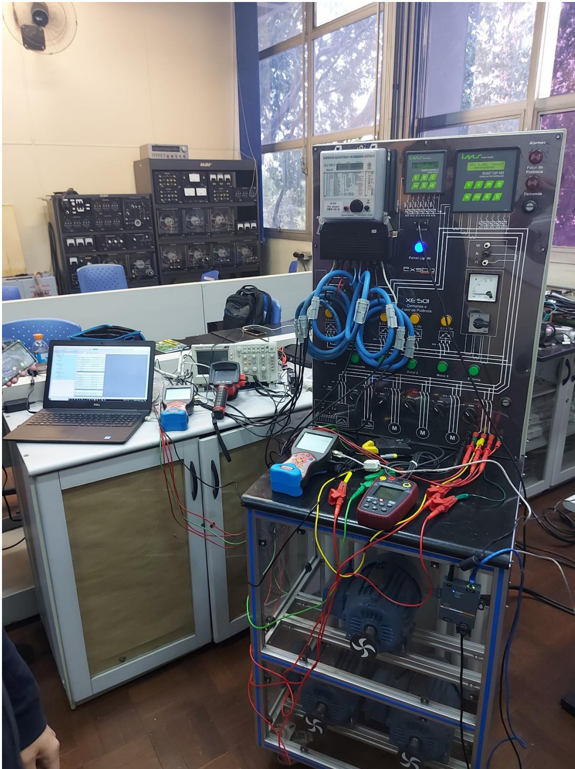
Figura 5 - Estrutura completa para ensaio de correção de Fator de Potência Fonte: Arquivo pessoal dos autores
