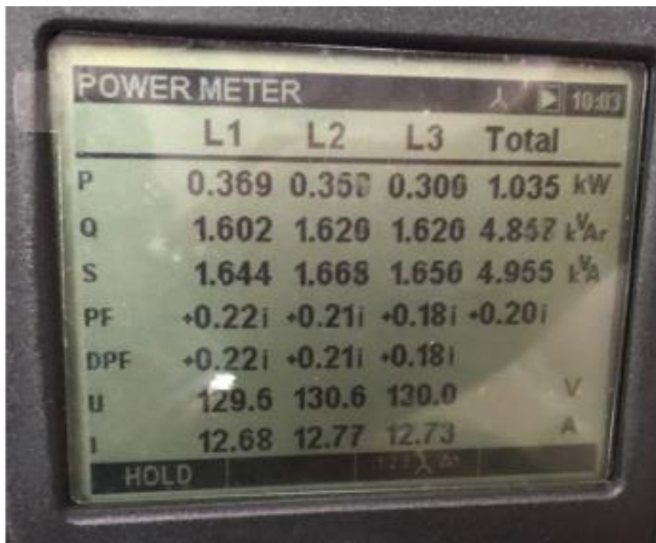
Figura 20 - Valores de potência ativa total, reativa total e aparente total sem correção Fonte: Arquivo pessoal dos autores
