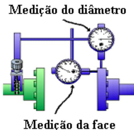
**Figure 1.17** Método Diâmetro-Face
