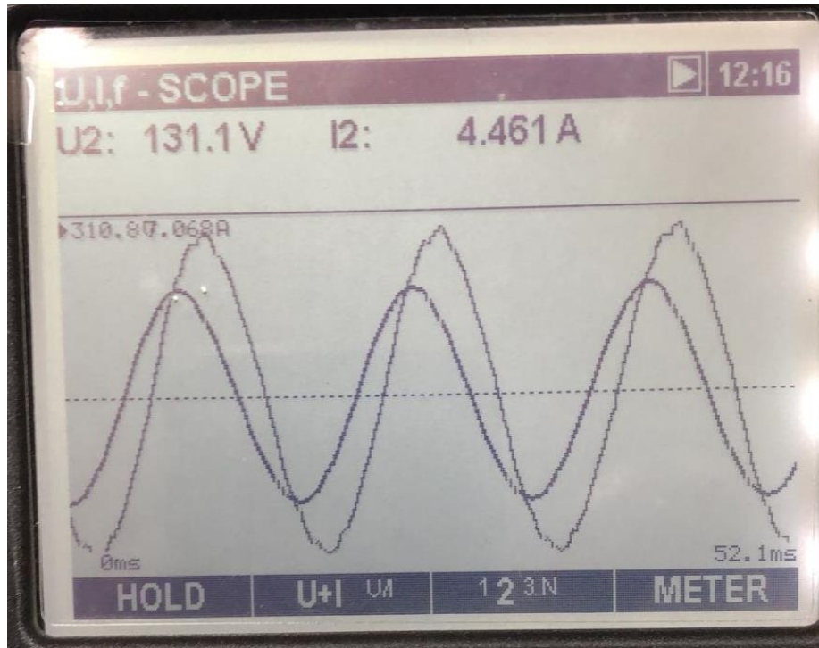
Figura 36 - Forma de onda da tensão U_2 e corrente I_2 corrigidas Fonte: Arquivo pessoal dos autores
