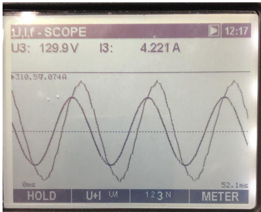
Figura 37 - Forma de onda da tensão U_3 e corrente I_3 corrigidas Fonte: Arquivo pessoal dos autores
