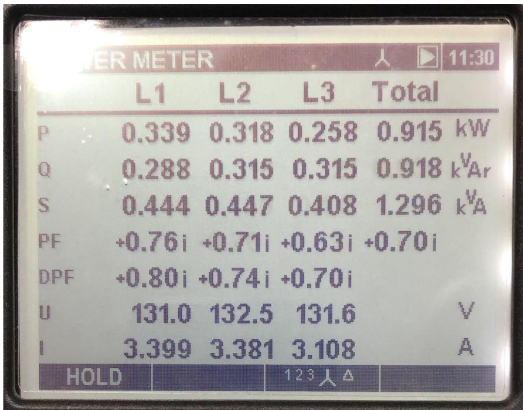
Figura 21 - Potências ativa, reativa e aparente por fase e a somatória das três fases Fonte: Arquivo pessoal dos autores
