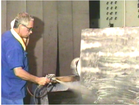
Aplicação do revelador por pulverização com pistola de pintura à esquerda e aplicação de revelador seco com pulverizador manual à direita.
