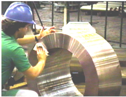
Remoção do penetrante com pano
